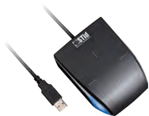
ENROLEUR USB BLUETOOTH Enroleur USB pour badges de proximité 13,56 MHz et Bluetooth REF 120.9500
